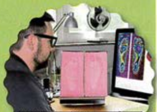
Mithilfe eines 3-D-Scans wird der vom Kunden eingeschickte Fußabdruck weiterverarbeitet
